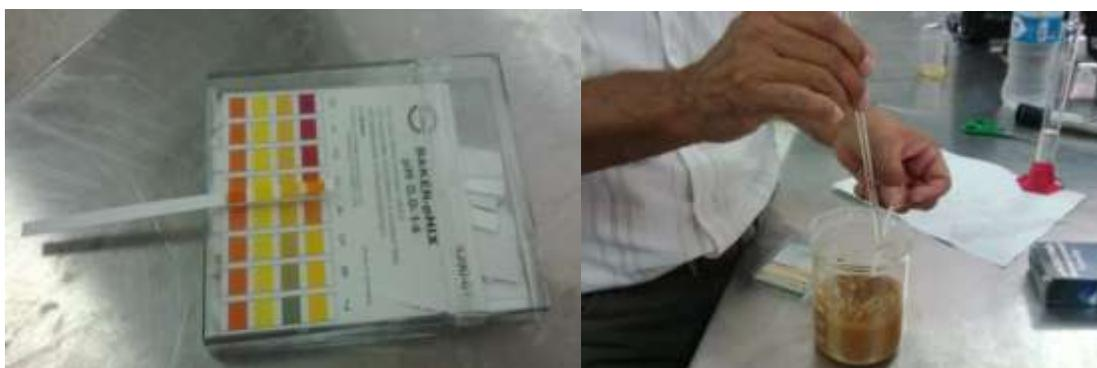
FIGURA 1.3B2: OBTENCIÓN DEL pH MEDIANTE TIRAS INDICADORAS
