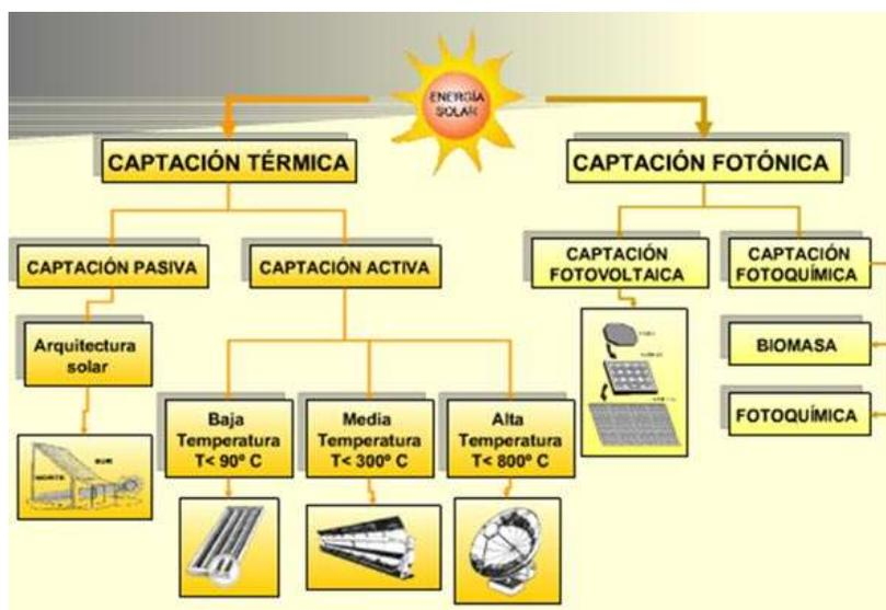
Figura 1. Formas de utilizar la energía solar.
