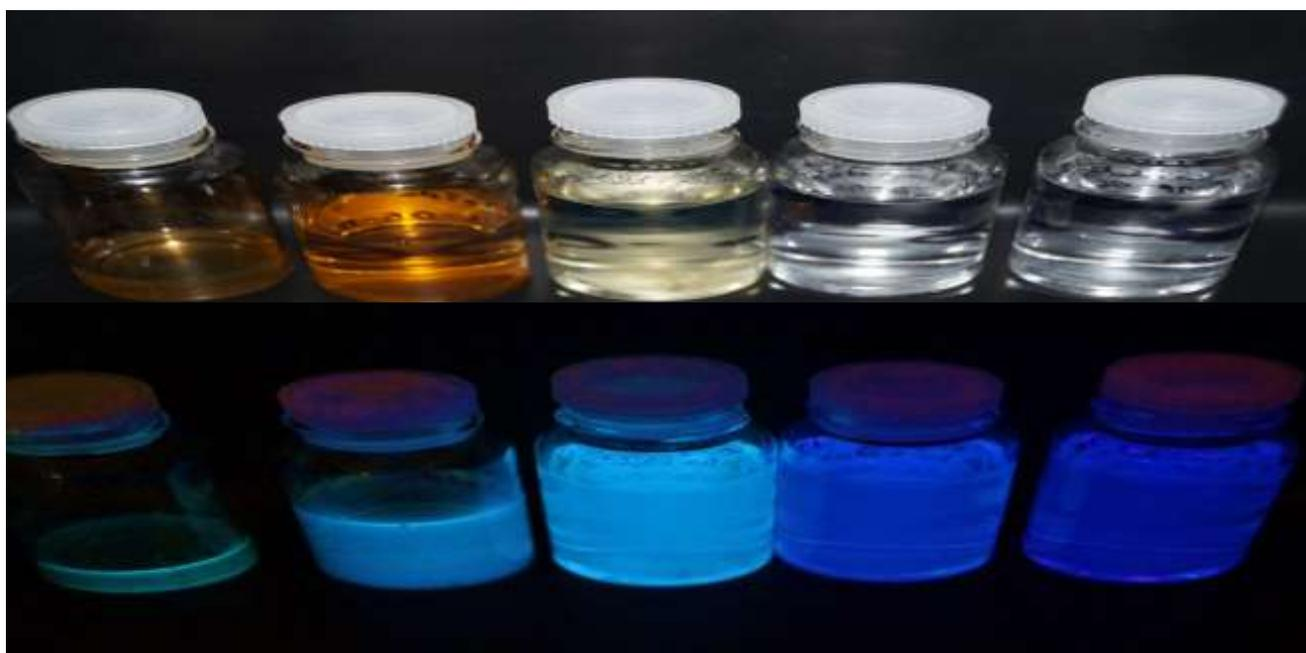
Figura 1.2. C-Dots con o-fenilendiamina a 120°C.
