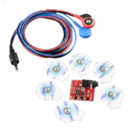
Figura 3.5. Sensores mioeléctricos seleccionados
