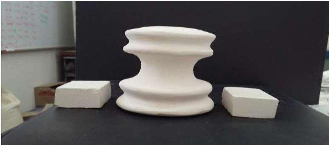
Figura 2.2. Prototipo sinterizado elaborado con la arcilla caolinítica y piezas para ensayos en el laboratorio
