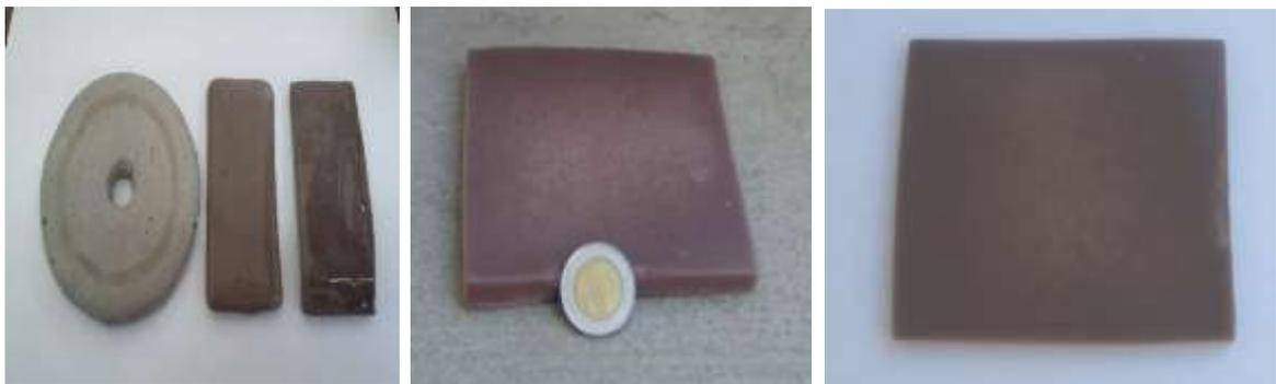
Fig. 2.1 Prototipos de Materiales vitrocerámicos obtenidos
